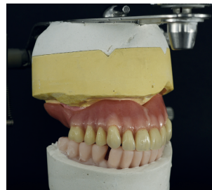
Рис. 17. Супраструктура, отлитая из распечатанного прототипа из выжигаемой смолы используя 3D-печать
